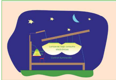
Lámparas focalizadas de bajo consumo y el control de su operación inciden directamente en el ahorro del consumo eléctrico dedicado a la iluminación.
