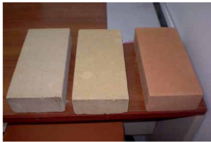
Ladrillo de bloque de tierra comprimido (BTC), material de elevada masa térmica.
