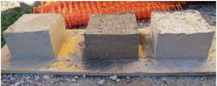
Preparación de probetas de tierra compactada para conocer su resistencia.
