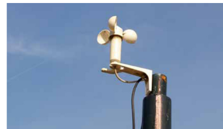
Anemómetro que controla la posición del panel fotovoltaico en función de la velocidad del viento, evitando que puedan volcarse los paneles en el caso que se superen ciertos valores.
